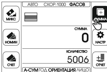
Для того, чтобы включить режим СУММИРОВАНИЯ нажмите на иконку **СУММА** на дисплее или на соответствующую кнопку на панели управления.
