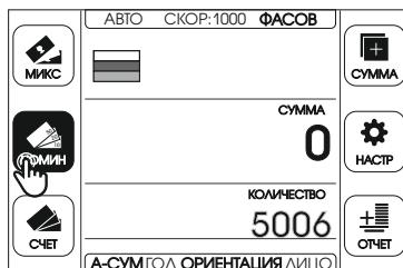
Для того, чтобы включить режим НОМИНАЛ нажмите на иконку **НОМИН** на дисплее или на соответствующую кнопку на панели управления. Пока режим активен иконка **НОМИН** на дисплее будет подсвечиваться синим цветом.
