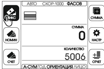
Для того, чтобы включить режим МИКС нажмите на иконку **МИКС** на дисплее или на соответствующую кнопку на панели управления. Пока режим активен иконка **МИКС** на дисплее будет подсвечиваться синим цветом.
