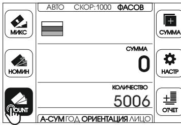
Для того, чтобы включить режим СЧЕТ нажмите на иконку **СЧЕТ** на дисплее или на соответствующую кнопку на панели управления. Пока режим активен иконка **СЧЕТ** на дисплее будет подсвечиваться синим цветом.
